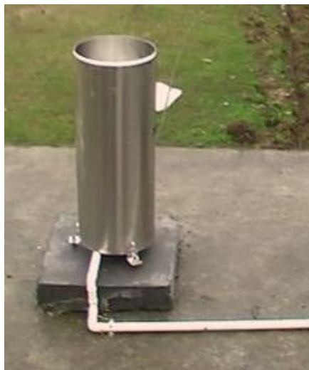
图 3-16 雨量计安装示意图
